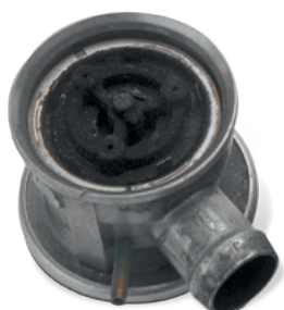
Daños por condensado de gas residual
